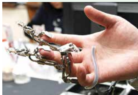
平成27年より可動式義指の製作を開始。3Dプリンターで部品の試作品を作るところから行っている。(愛和義肢製作所は、Didrick Medical社のX-Finger®の正規製造元)
